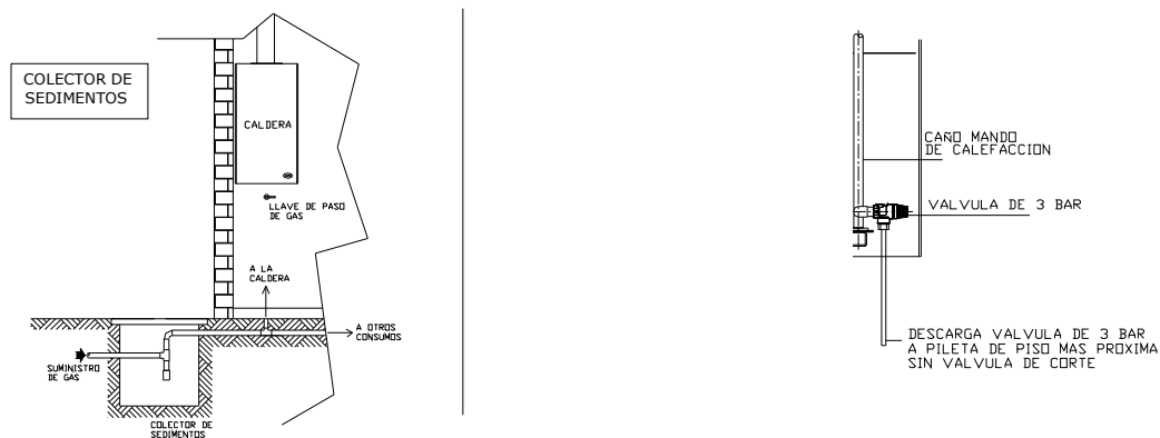
Figura II k: Colector de sedimentos y descarga de Valvula de 3 bar
